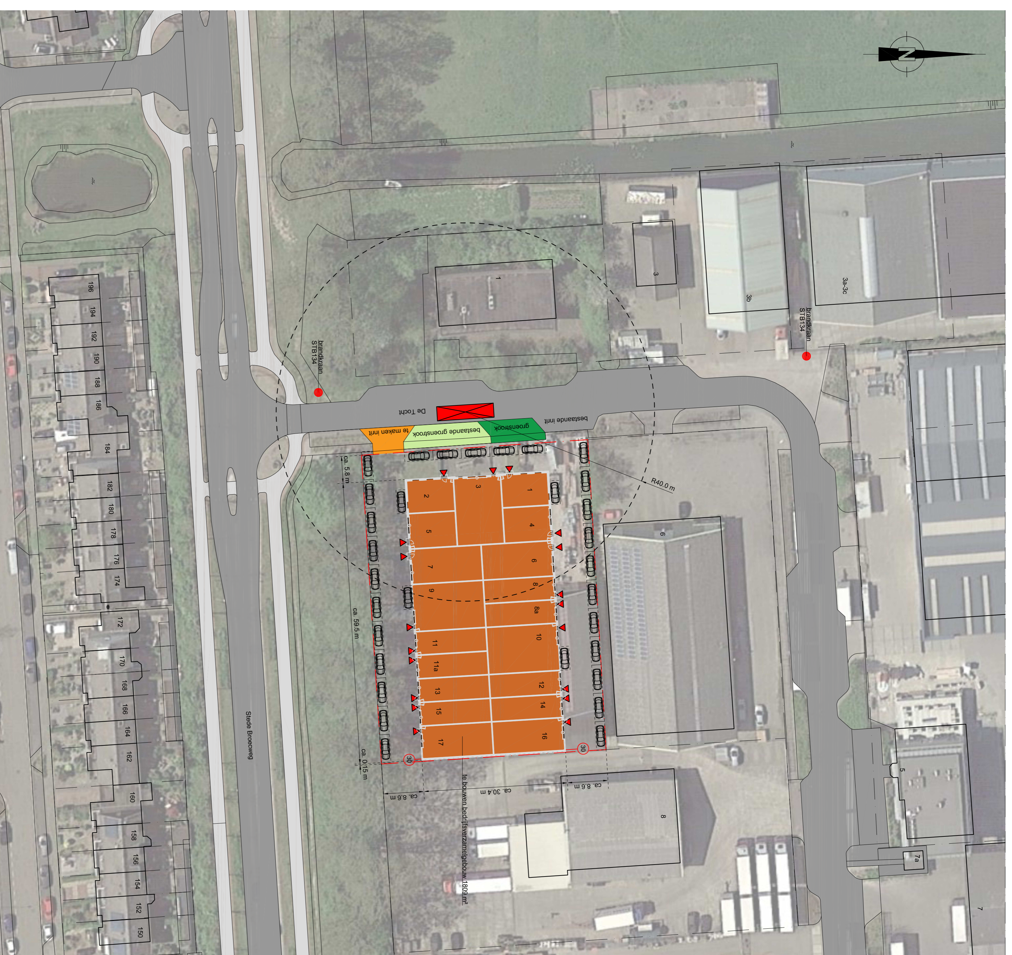
Gewijzigde situatie Bruto opp. te bouwen 1809 m 2 Bruto inhoud te bouwen 12810 m 3
